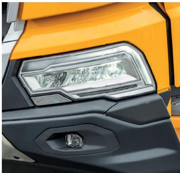
Ytterbelysning med LED-teknik
