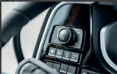
Kontrollpanel för ytterbelysning
