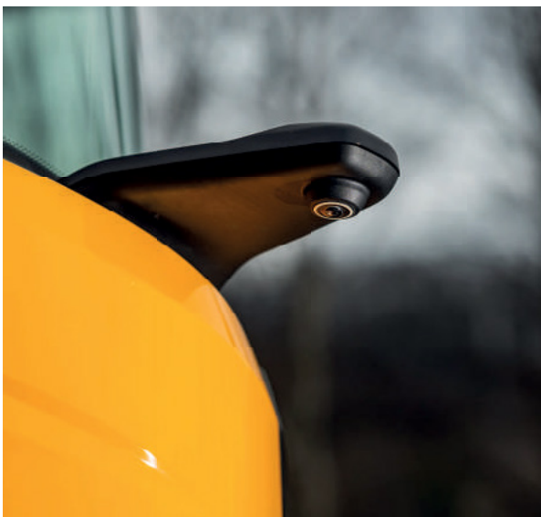
"Corner View"-systemet för bättre sikt runt fordonet
