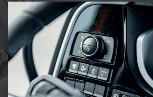
Kontrollpanel för ytterbelysning
